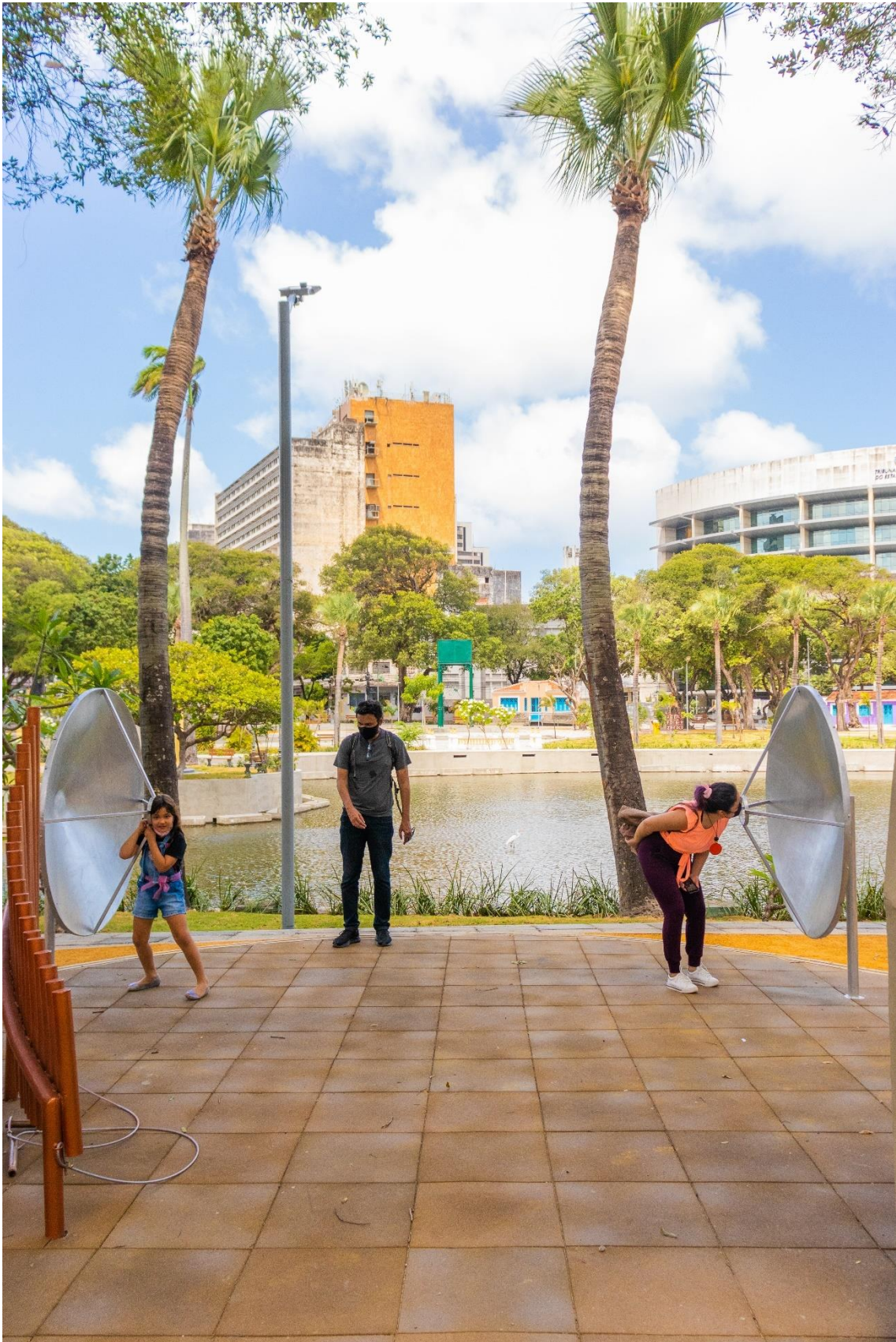
Os refletores parabólicos utilizam de princípios físico-matemáticos de reflexão de energia sonora de raios incidentes paralelos ao eixo em superfícies convexas até um ponto focal
