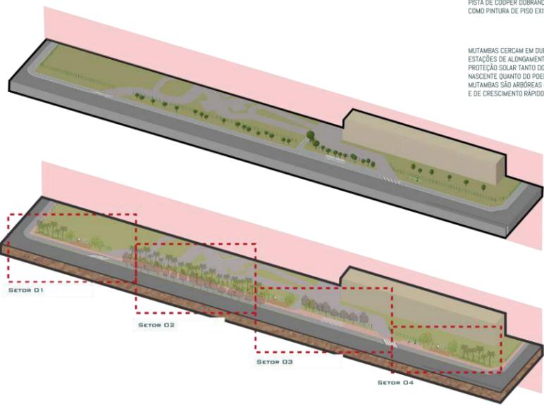
AMPLIAÇÃO DE CALÇADA COM PISTA DE COOPER DE MATERIAL TOTALMENTE DISTINTO DA CALÇADA EXISTENTE PARA NÃO DAR IMPRESSÃO DE REMENDO. A PISTA DEVERÁ TER MARCAÇÃO DE DISTÂNCIA PERCORRIDA
